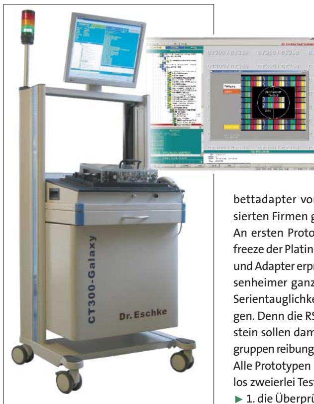
Bild 1: Das CT300 Galaxy-Testsystem mit LCD-Testbild
