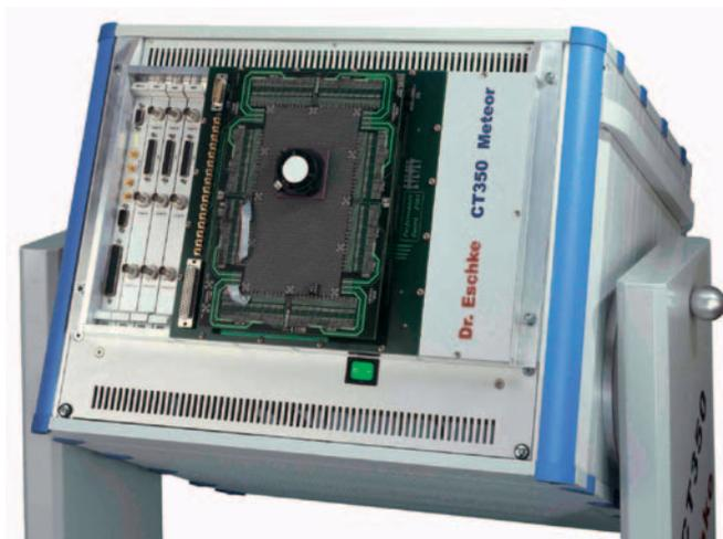
Bild 2: CT 300 Comet S mit Loadboard für das Halbleiter-Engineering.
