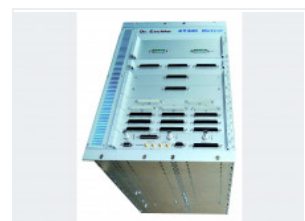
Überzeugt hat unter anderem die Schnelligkeit der Signalübertragung zwischen Tester und PC über die USB2-Schnittstelle und das rasche Abarbeiten der Befehle im Rechner. Das ist vor allem dem sehr schnellen Mikroprozessor mit RISC/DSP-Struktur im zentralen Tester-Steuermodul zu verdanken, der alle Aktionen in Echtzeit abarbeitet. (Bild: Dr. Eschke)
