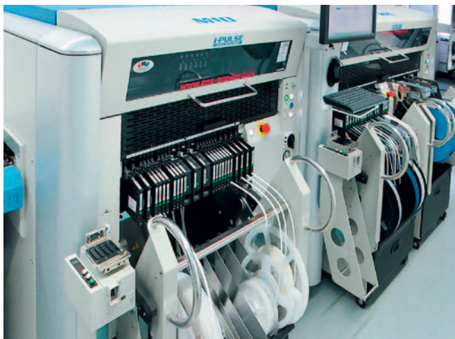
Die Bestückungsvollautomaten M10 und M20 der Marke i-Pulse verrichten bei Slimtec-EMS ihre Dienste.
